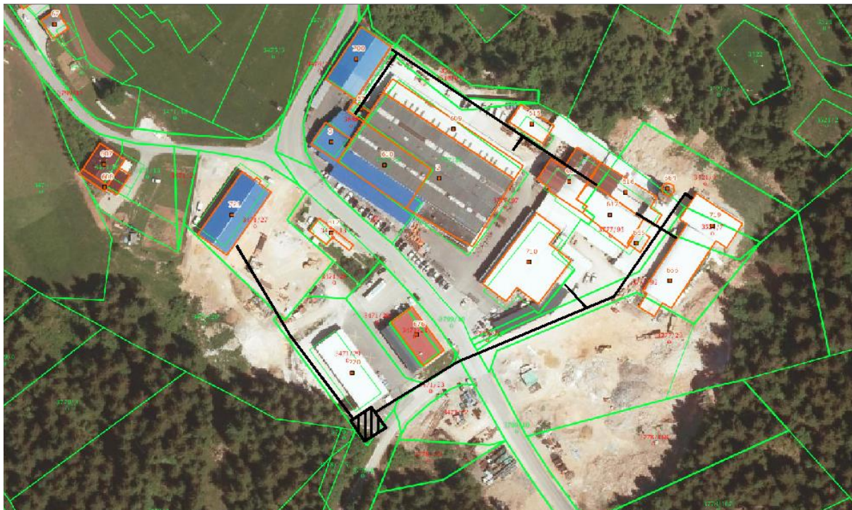
Slika 11.2: Shematski prikaz sistema DOLB Mali Log
