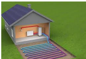
Slika 6: Delovanje TČ (horizontalni kolektor) zemlja – voda
