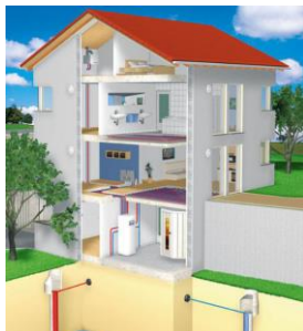
Slika 5: TČ voda – voda
