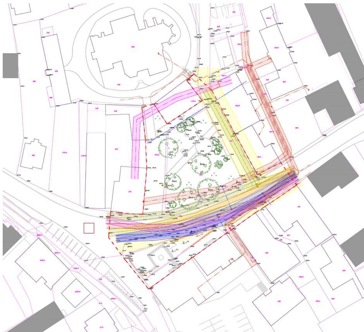
Slika 4: Situacija obstoječega stanja – geodetski posnetek.
