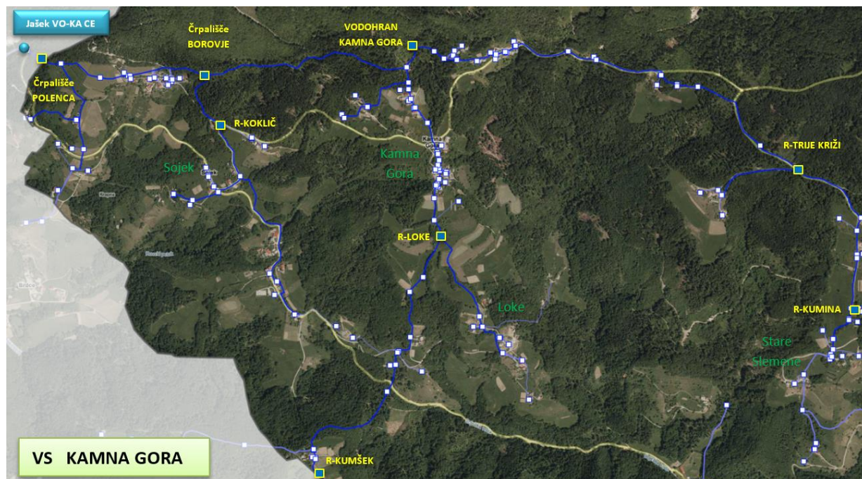
Slika 15: Vodovodni sistem KAMNA GORA
