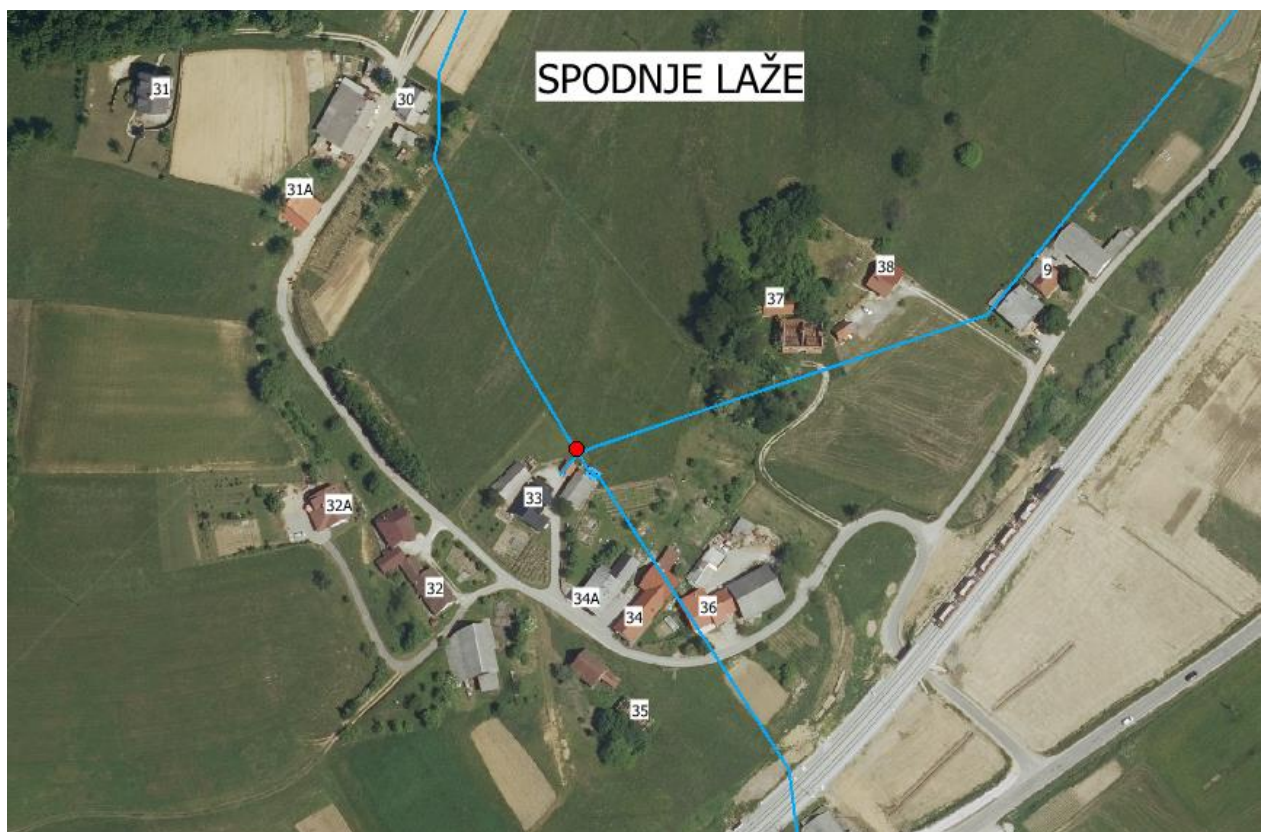
Slika 18: Vodovodni sistem Spodnje Laže - Hidrantno omrežje
