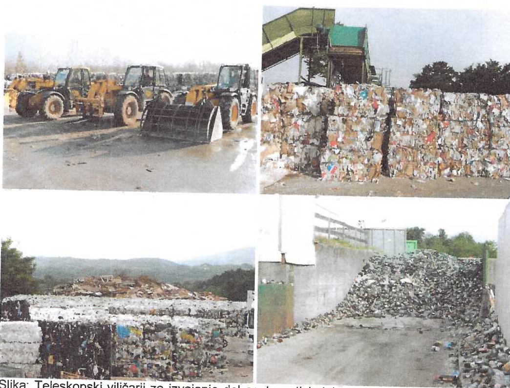
Slika: Teleskopski viličarji za izvajanje del centru, stiskalnica z balirko za ločene frakcije odpadkov, balirani odpadki, skladiščenje steklene embalaže
