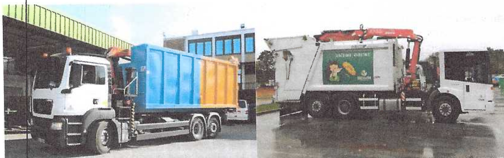
Slika: Prikoličar z dvo-prekatnim kotalnim zabojsnikom ter namensko vozilo za stiskanje ločeno zbranega papirja in kartona ter mešane embalaže iz plastike in kovin
