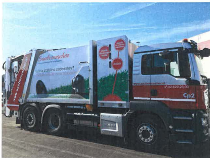
Fotografija 19: Vozilo za pranje zabojnikov za zbiranje bioloških odpadkov
