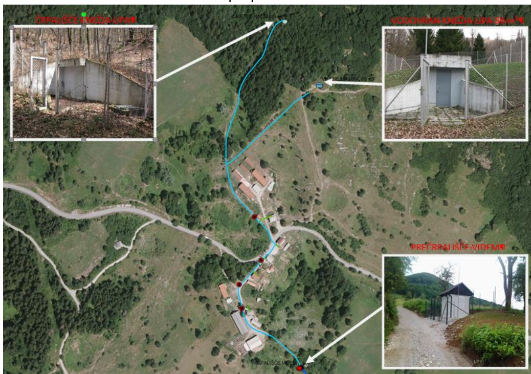
Shema 3: Shema vodovodnega sistema Knežja Lipa (črpališče, vodohran, prečrpališče, omrežje, hišni priključki, hidranti)
