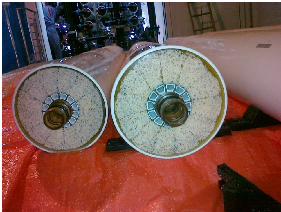
Slika 12: Modulni sistem UF naprave
