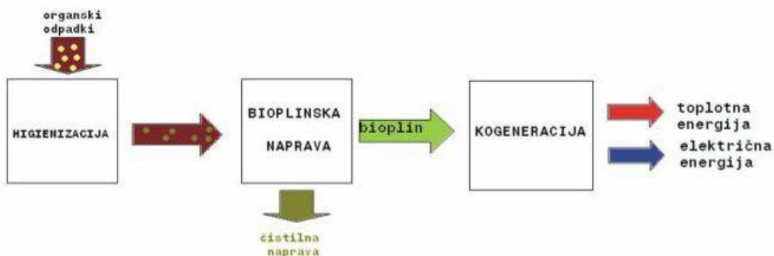
Slika 43: Shema poteka procesa termofilne predelave organskih odpadkov v energijo
