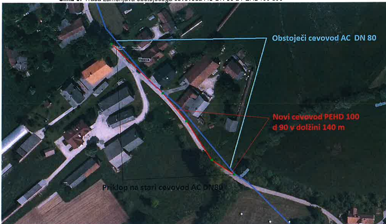
Slika 3: Trasa zamenjava obstoječega cevovoda AC DN 80 z PEHD100 d90
