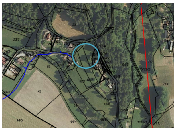
Slika 8: Prikaz opremljenosti s komunalno in energetska infrastrukturo, kjer je z rdečo barvo prikazan srednje napetostni prostozračni daljnovidni vodovod električne energije in z modro vodooskrbne cev sekundarnega omrežja vodovoda (vir: https://gis.iobcina.si/gisapp/Default.aspx?a=radljeobdravi , julij 2021)
