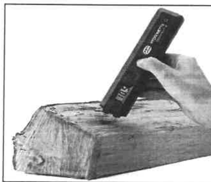
Slika 46; Kontrola vlažnosti drv z enostavnim merilnikom (Vir: www.baudochselbst.com )
