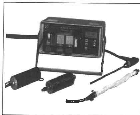
Slika 76; Specialni sodoben merilnik prahu in CO za kurilne naprave na trdno gorivo (Vir: www.Wöhler.de )
