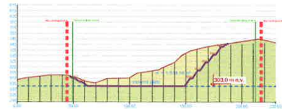
2/ TEHNIČNA SANACIJA KAMNOLOMA prečni prerez B-2
