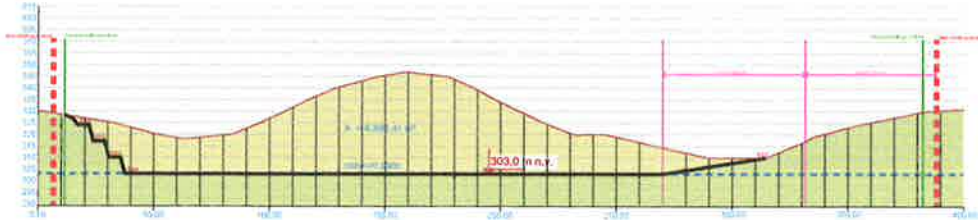
2/ TEHNIČNA SANACIJA KAMNOLOMA vzdolžni prerez A-2
