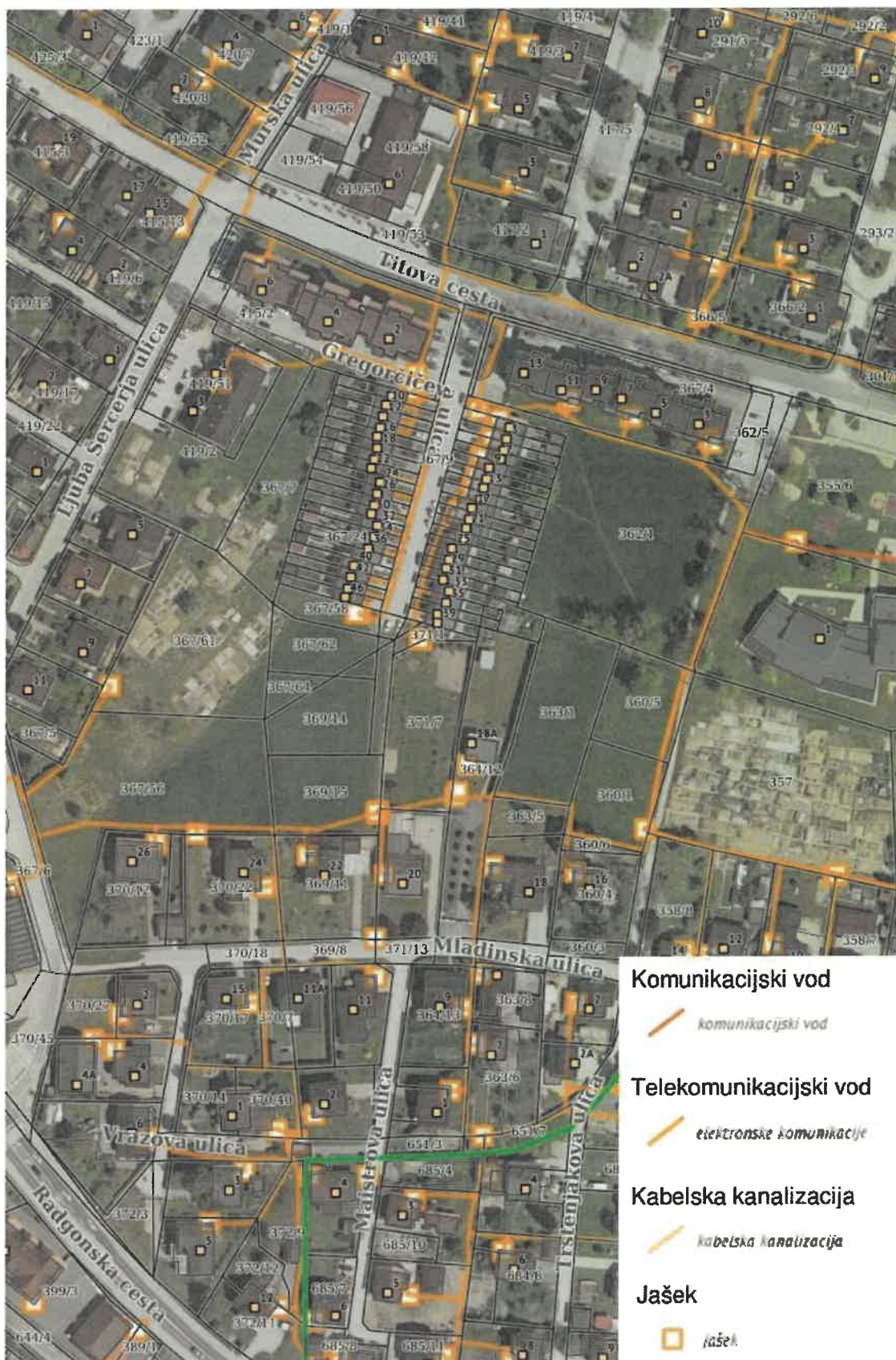
Slika 9: obstoječe telekomunikacijsko omrežje, vir: https://e-terra.si , september 2022
