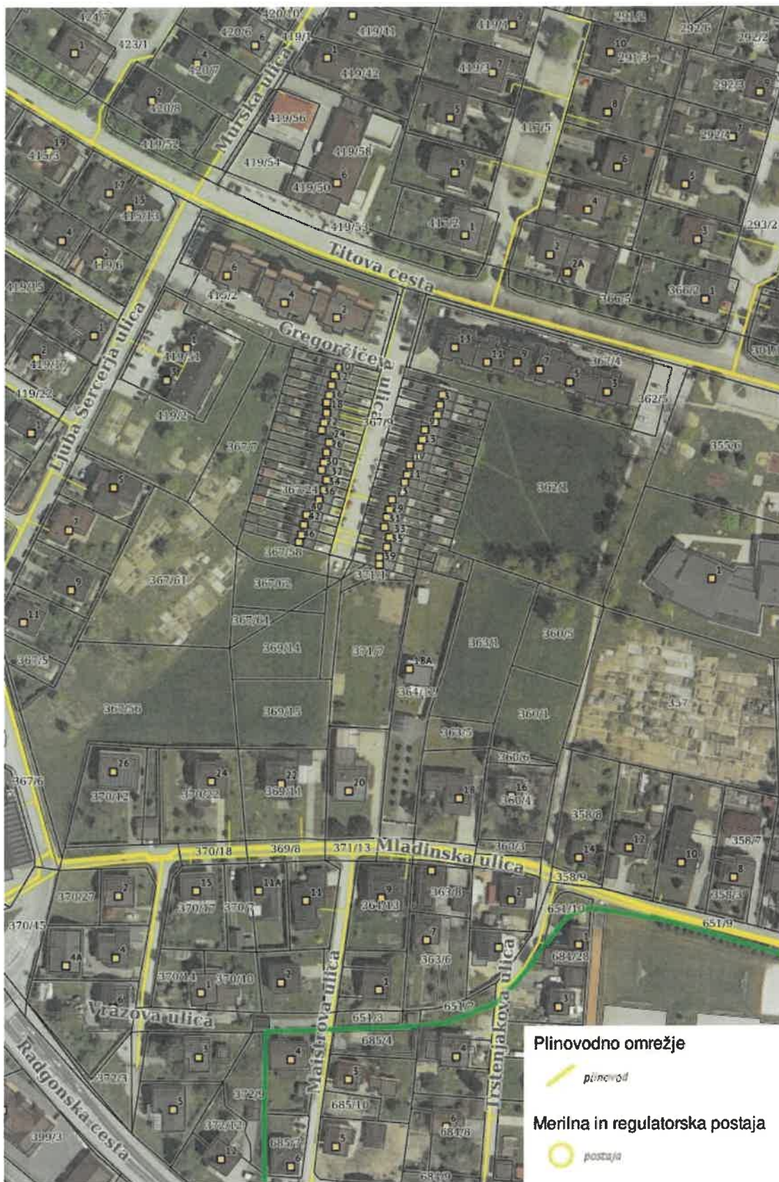
Slika 8: obstoječe plinovodno omrežje, vir: https://e-terra.si , september 2022
