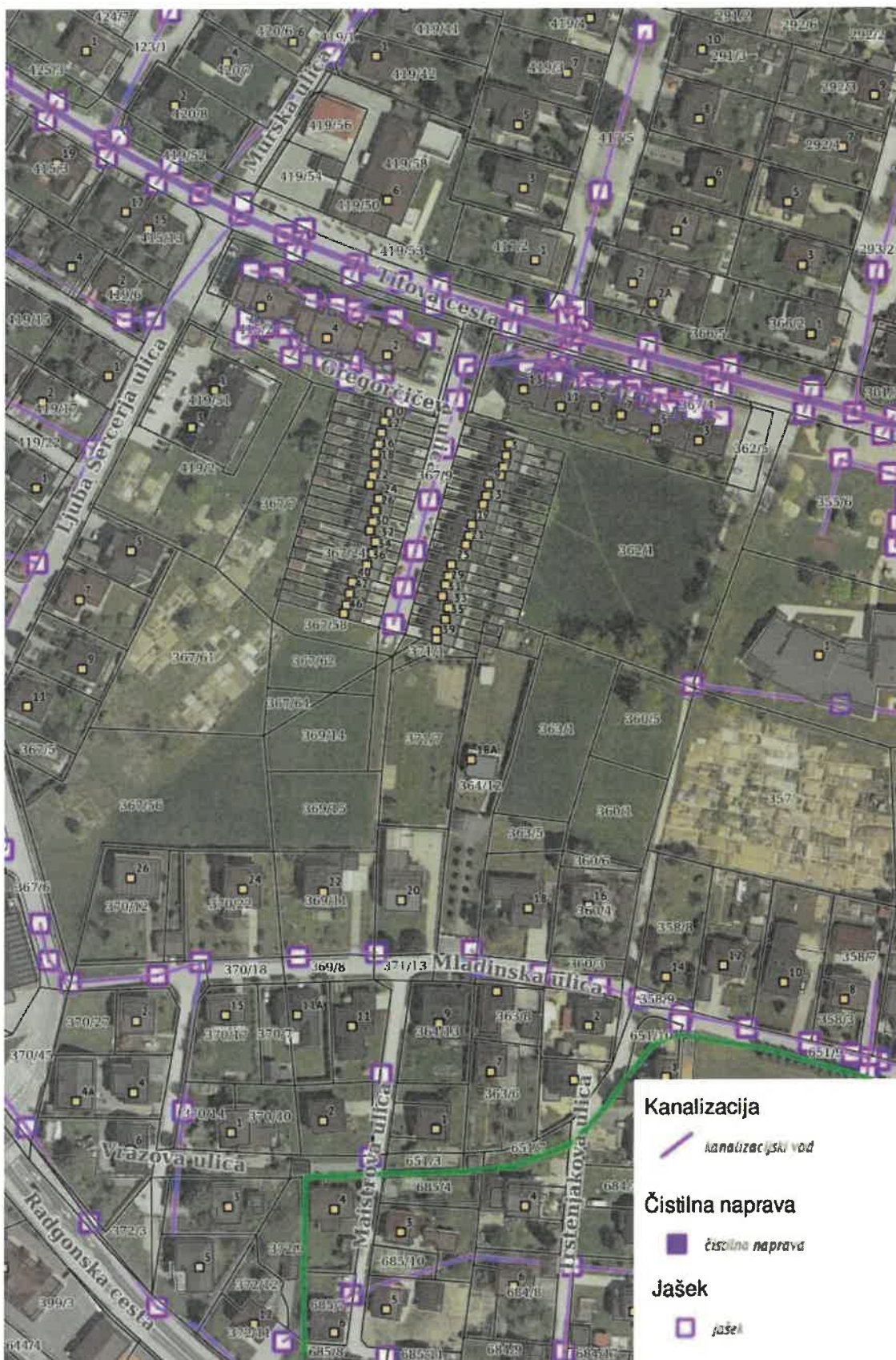
Slika 6: obstoječa fekalna kanalizacija, vir: https://e-terra.si , september 2022
