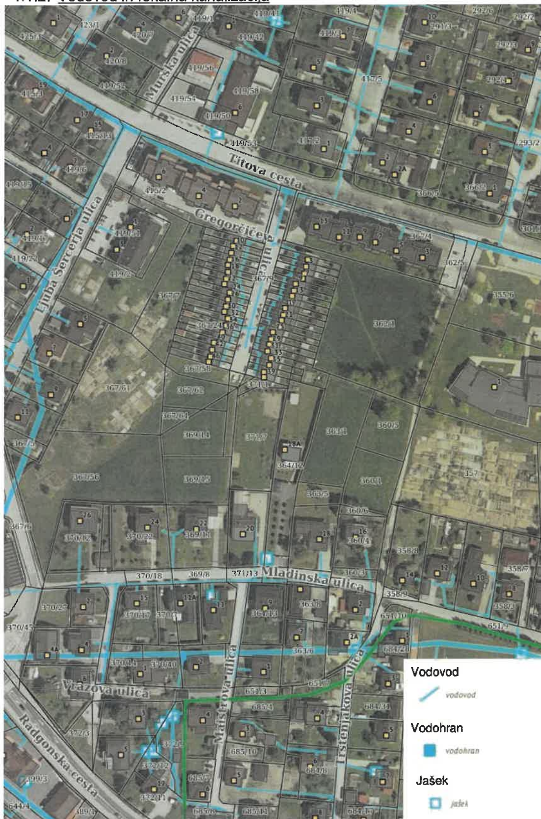
Slika 5: obstoječa vodovodna kanalizacija, vir: https://e-terra.si , september 2022
