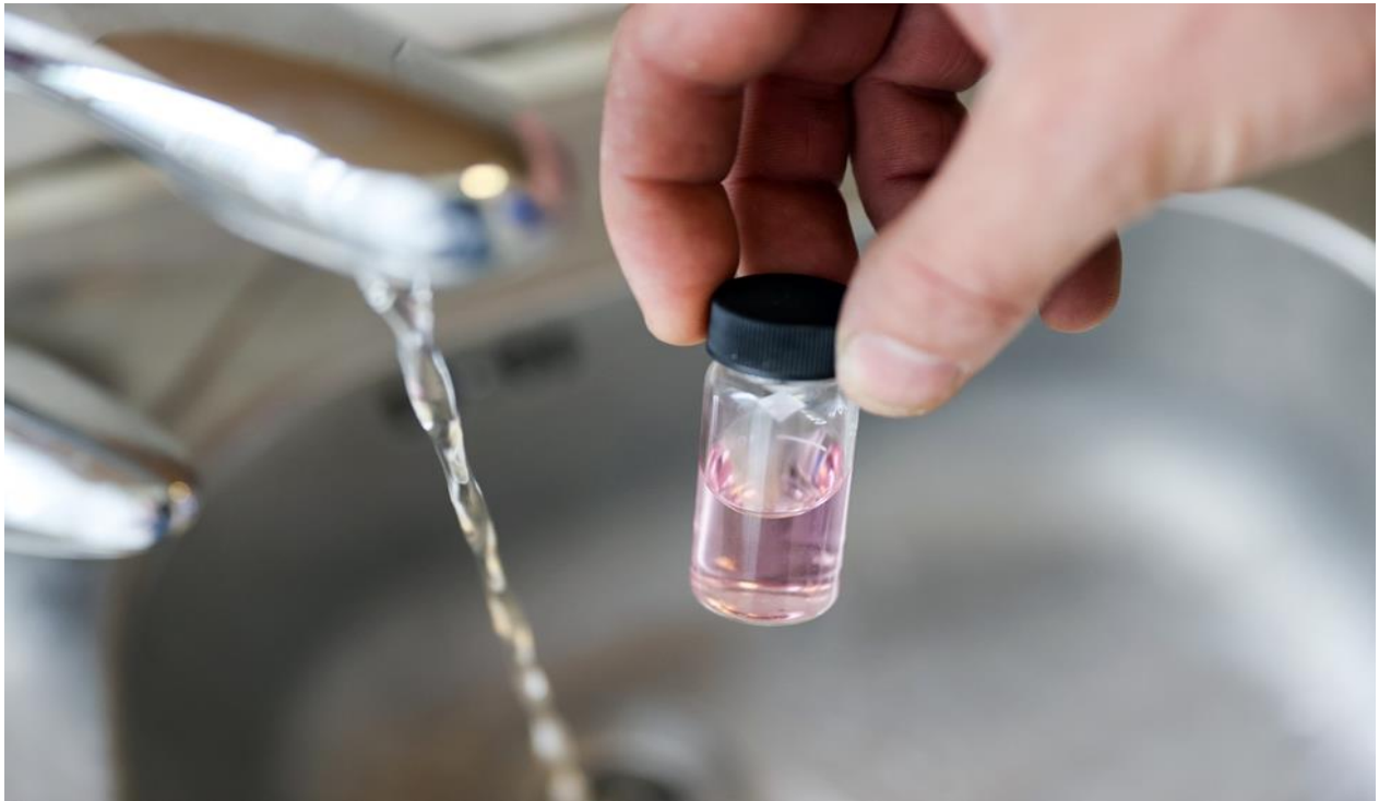
Slika 6: Meritev vsebnosti prostega klora v pitni vodi
