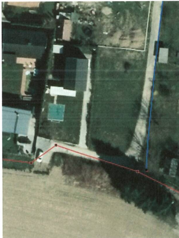
Slika 10: v neposredni bližini se nahaja obstoječi vodovod (V) in obstoječi komunalni vod za odvajanje fekalnih vod, vir: iobčina
