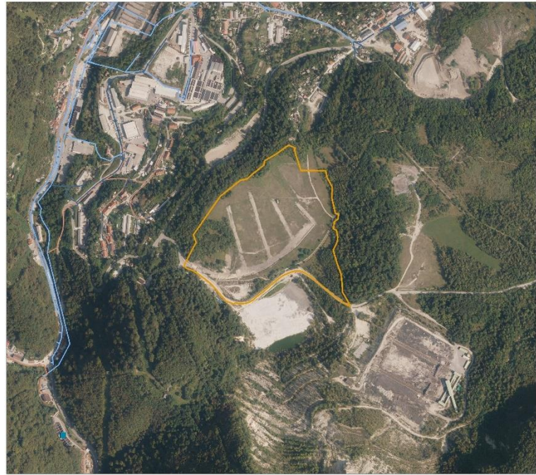
▭ območje OPPN O mrežje odpadnih voda — mešani vod ■ centralna čistilna naprava — fekalni vod — meteorni vod
