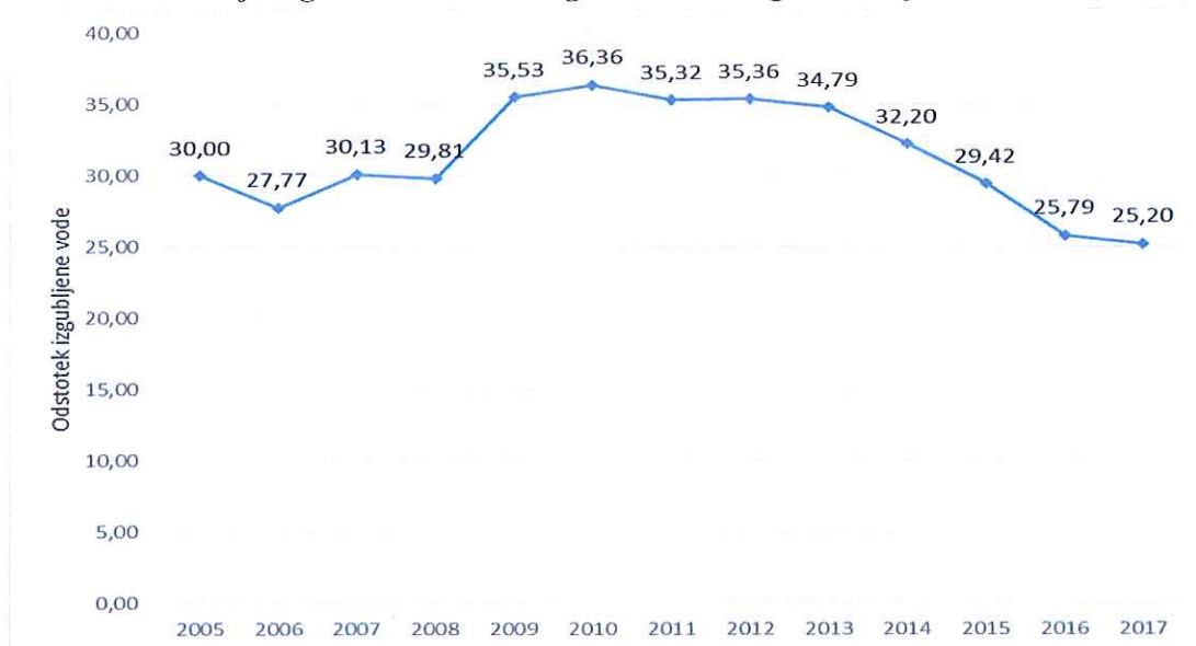
Graf 11: Gibanje izgub vode iz Javnega vodovodnega omrežja Ormož
