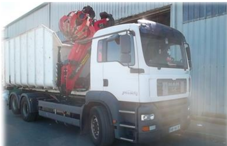
Slika 13: Vozilo za zbiranje odpadkov s kotalnih prekucnikov
