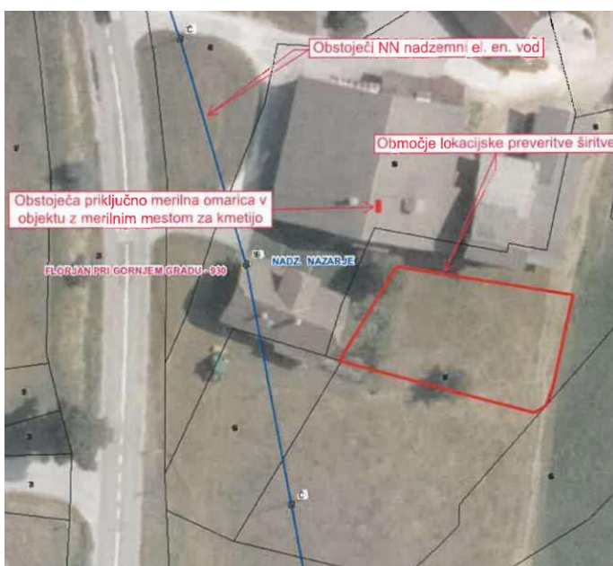
Slika 6: prikaz elektroenergetskega omrežja
