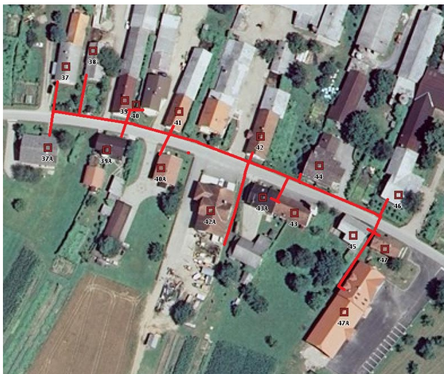
Slika 11.2: Daljinsko ogrevanje na lesno biomaso Anton Kekec.
