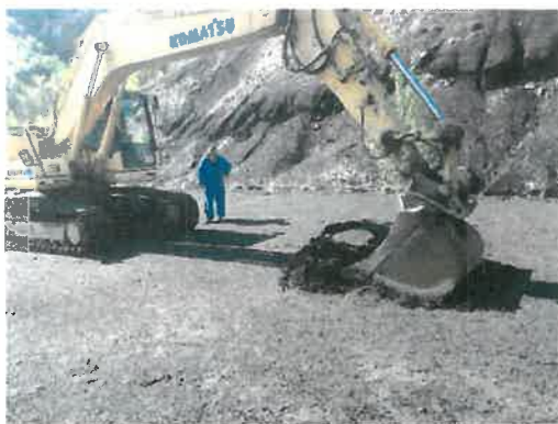
Slika 2 : Odvzem monolitnega vzorca iz testnega polja
