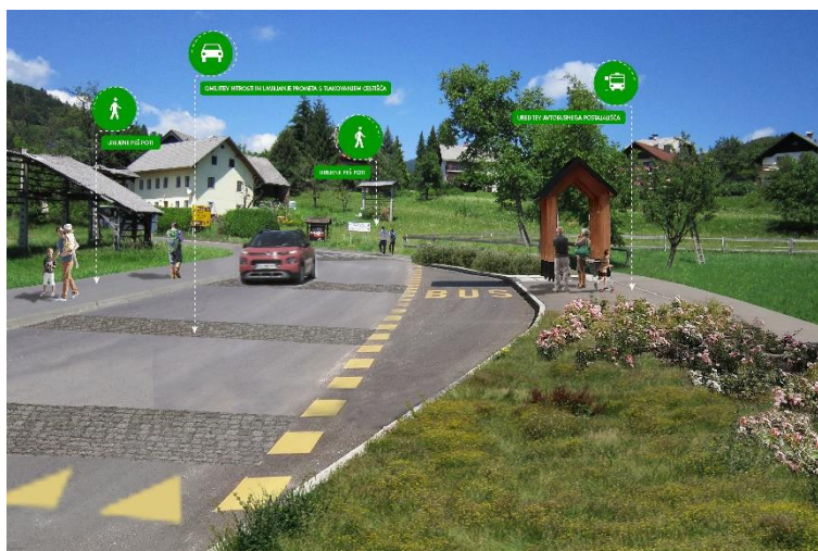
Vizija – primer ureditve avtobusnega postajališča ter prometnih površin za zagotovitev kakovostne dostopnosti za vse uporabnike v Spodnjih Gorjah
