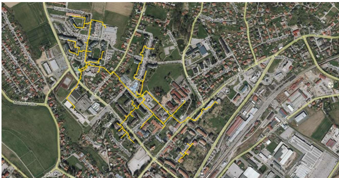
Slika 1: Prikaz obstoječe infrastrukture – toplovodnega omrežja
