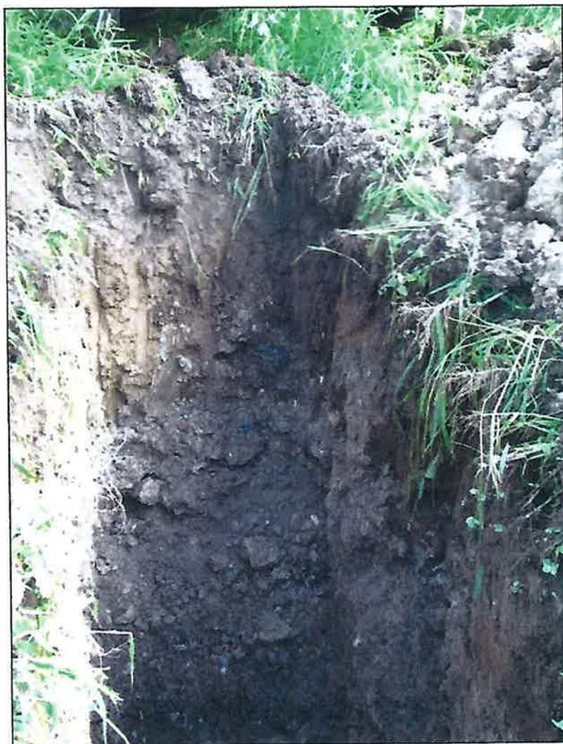
Slika 4: Sondažni izkop z vidnimi plastmi humusa, gline in peščenega proda
