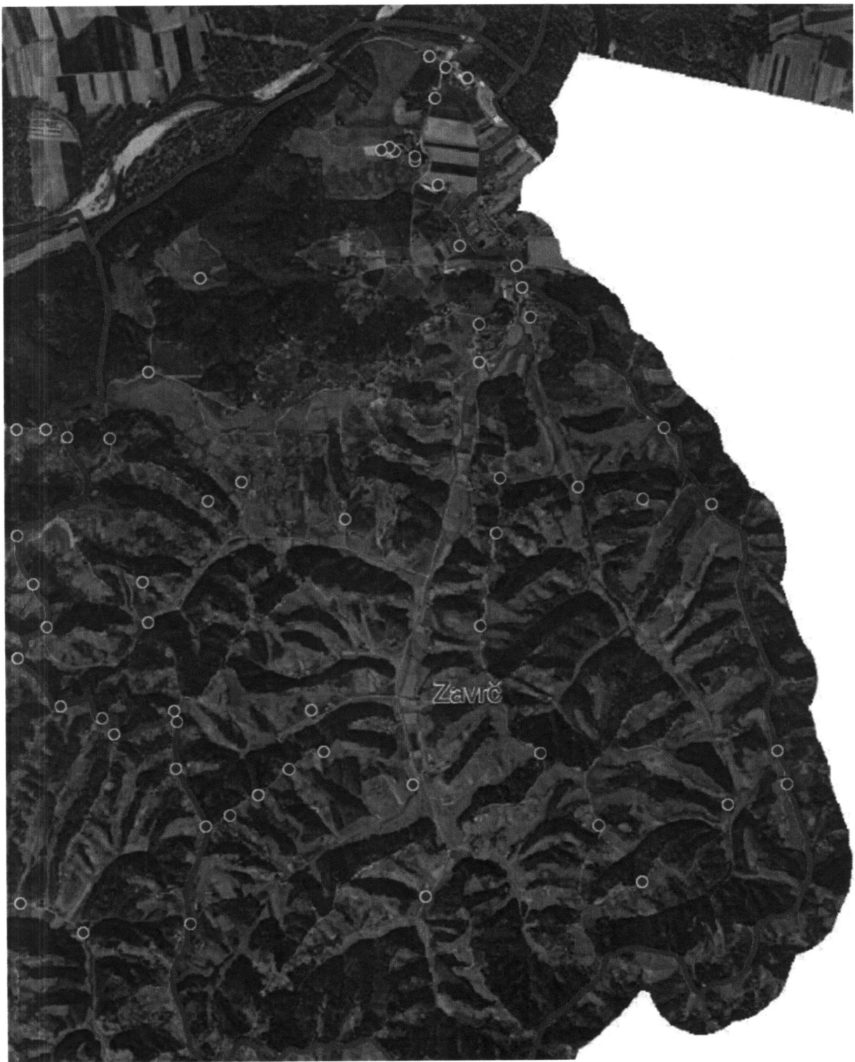
Slika 2-39: Hidranti občina Zavrč
