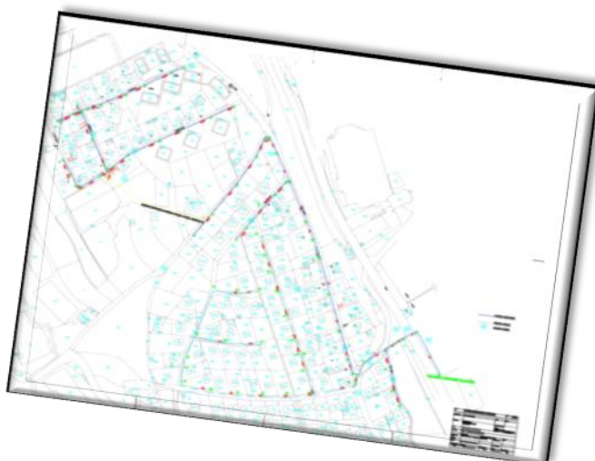
Slika 14: Trasa kanalizacije Nova Dobrava
