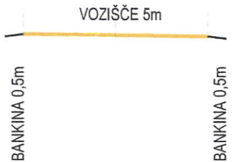
PREČNI PROFIL CEST šir. 6m
