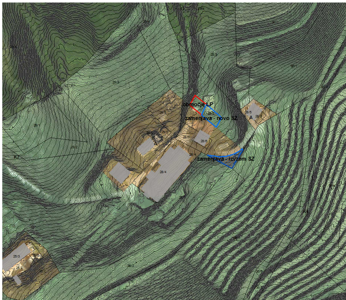
Slika 2: Prikaz območja LP na Lidar posnetku, ki prikazuje naklon terena.
