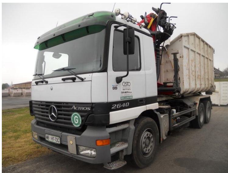
Fotografija 17: Vozilo za prevoz kotalnih prekucnikov
