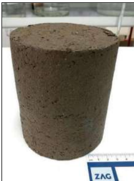
Slika 12.75: Izdelani kompozit iz blata ČN in pepela 65 .
