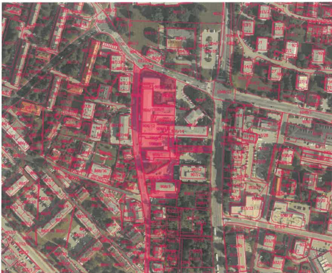
Grafika 3: Zemljiško katastrski prikaz – obarvan izsek za parcele na območju LP (vijolično)
