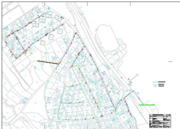
Slika 3: Trasa kanalizacije Nova Dobrava 2
