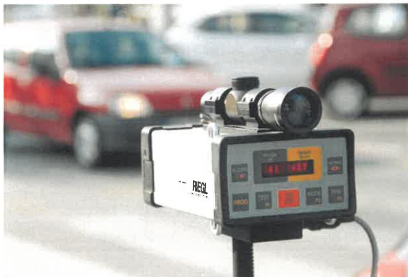
Slika 11: Laserski merilnik hitrosti tip LR 90/235/P
