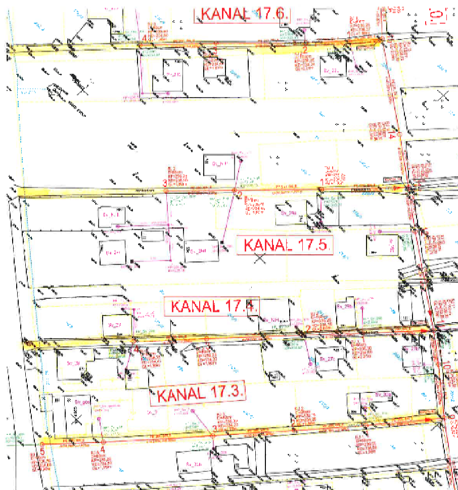
Slika 7-26: GRADBENA SITUACIJA KANAL-a 17.3. 17.4, 17.5, 17.6 izsek iz projektne dokumentacije
