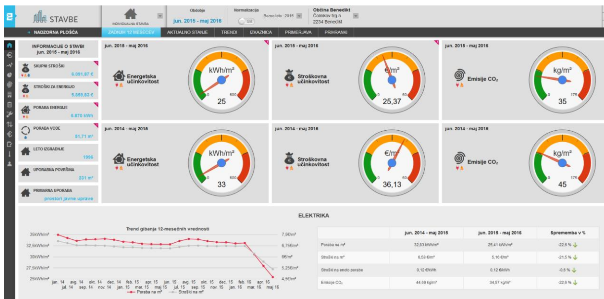
Slika 2: Računalniško podprt sistem za spremljanje in analizo rabe energije in energentov v stavbah
