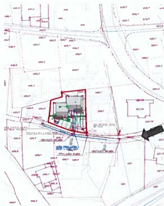
Slika 4: Prikaz poteka javne komunalne in energetske infrastrukture ter možnih priključkov objekta (vir: PGD št. 037, avgust 2006)
