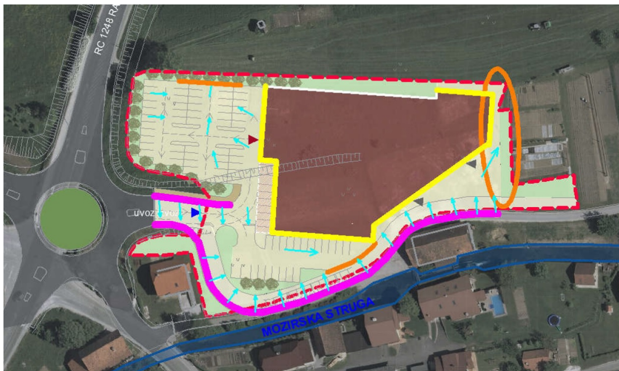
Slika 8: Predlog ukrepov na območju bodočega trgovskega centra; modre puščice nakazujejo smer naklonov načrtovane dostopne ceste, parkirišča in zunanjih ureditev, vijola je načrtovan pločnik z robnikom dvignjen nad nivojem ceste, z oranžno je označen robnik (na severnem robu Z parkirišča) in podporni zid (na vzhodnem delu J parkirišča, ki je nivoju parkirnih (asfaltnih) površin, z oranžno je obkrožen del zunanjih površin z robniki v nivoju terena.
