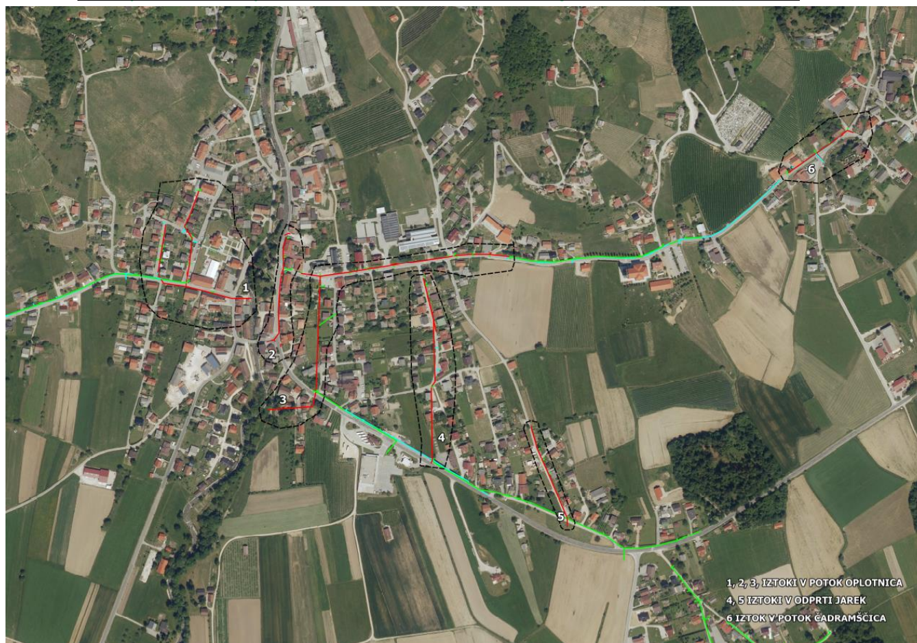
Slika 6: Obstoječi kanalizacijski sistem z označenimi iztoki – aglomeracija 1642 Oplotnica
