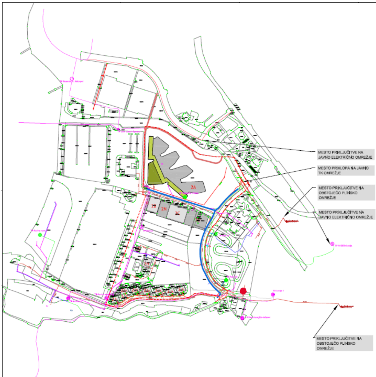
Slika 5.1: Prikaz ureditve poteka javne komunalne infrastrukture Območje OPPN Termalna riviera, št. projekta: 32/12, julij 2018, št. risbe: 5b
