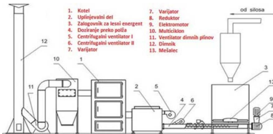
Slika 5/4: Prikaz procesa ogrevanja na lesno biomaso
