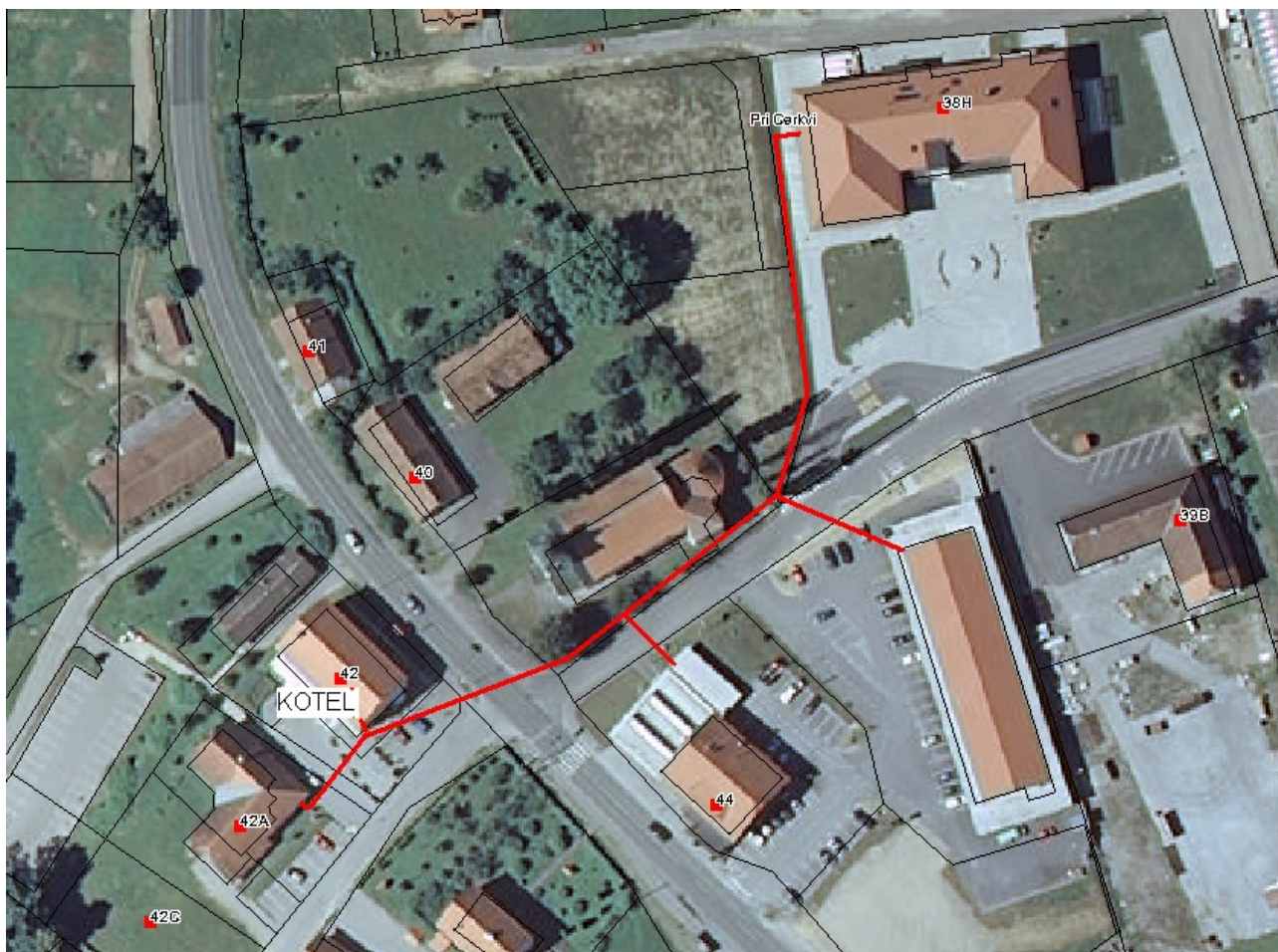
Slika 9.7: Predvidena trasa toplovodnega omrežja za DOLB
