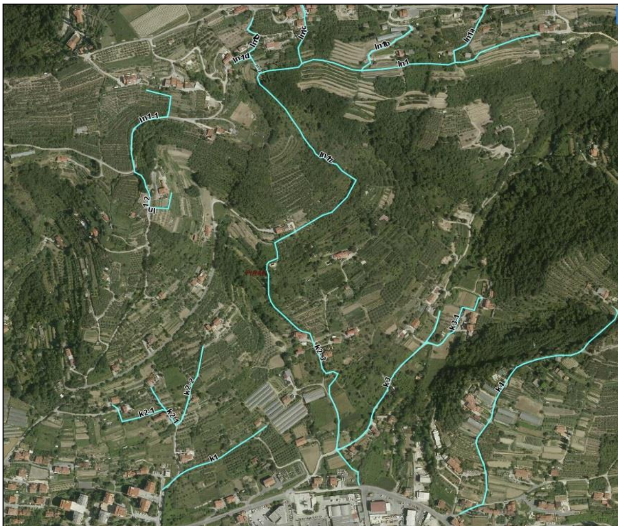
Slika 7: prikaz poteka predvidenih novih tras kanalizacijskega omrežja
