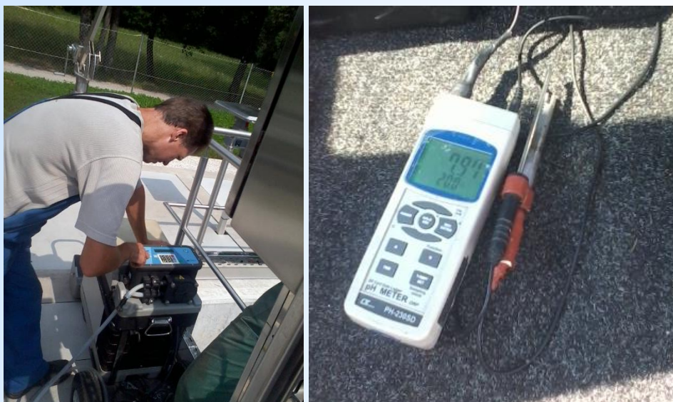
Slika 18: Odvzem vzorca odpadnih voda
