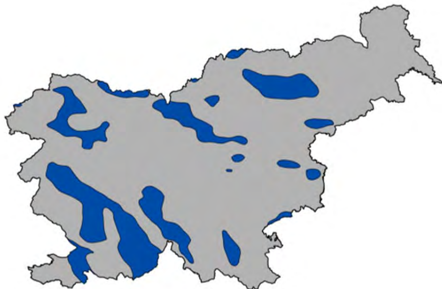
Slika 1: Vetrovno primerna območja – območja s povprečno hitrostjo vetra več kot 4,5 m/s 50 m nad tlemi v obdobju 1994-2000 iz modela Aladin DADA (vir: Celovit pregled potencialno ustreznih območjih za izkoriščanje vetrne energije - strokovna podlaga za NEP 2010-2030, Aquarius d.o.o., februar 2011)
