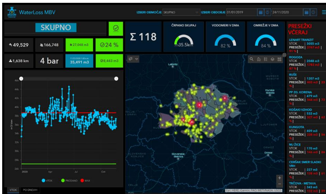
Slika 11: Program WaterLoss MBV – inovativni nadzorni program za spremljanje porab in pretokov vode v merilnih območjih na podlagi 49.529 vodomero, ki ga je ustvarilo Javno podjetje Mariborski vodovod. Vir: Mariborski vodovod, javno podjetje, d.d.
