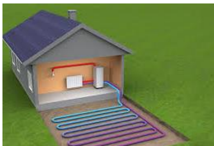
Slika 8: Delovanje TČ (horizontalni kolektor) zemlja – voda
