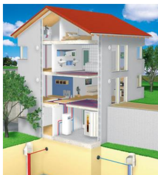
Slika 7: TČ voda – voda
