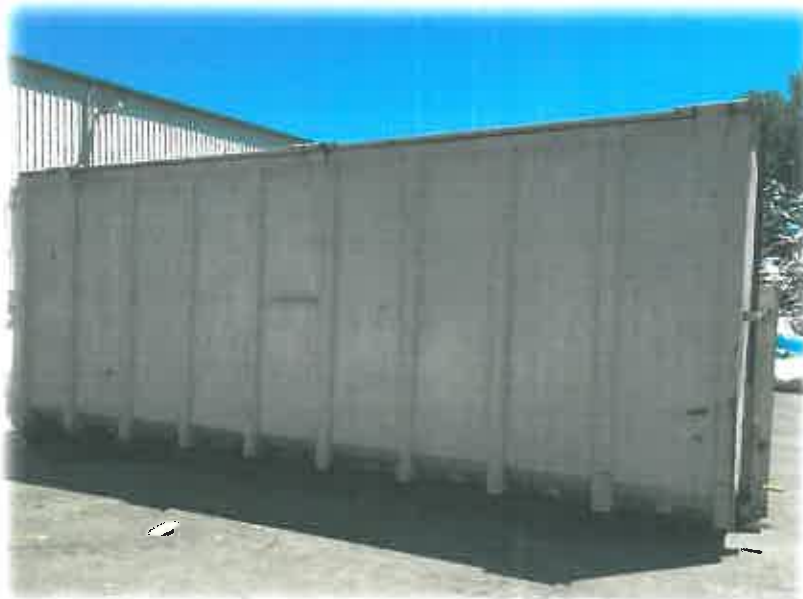
Slika 2: 30 m 3 keson za odvoz določenih vrst odpadkov.
