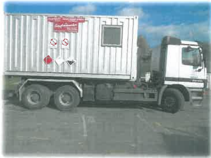
Slika 14: Kontejner za zbiranje in prevoz nevarnih odpadkov
