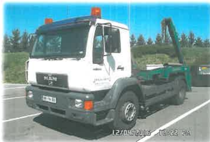
Slika 5: Vozilo za odvoz kontejnerjev manjših volumnov
