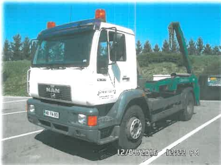
Slika 4: vozilo za kontejnerski prevoz določenih vrst odpadkov.
