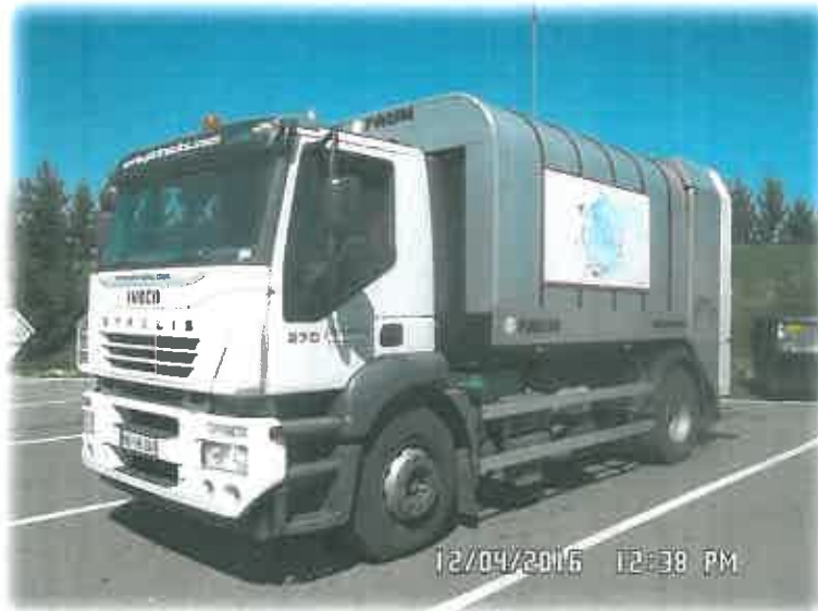
Slika 11: Vozilo za prevoz ločenih frakcij
