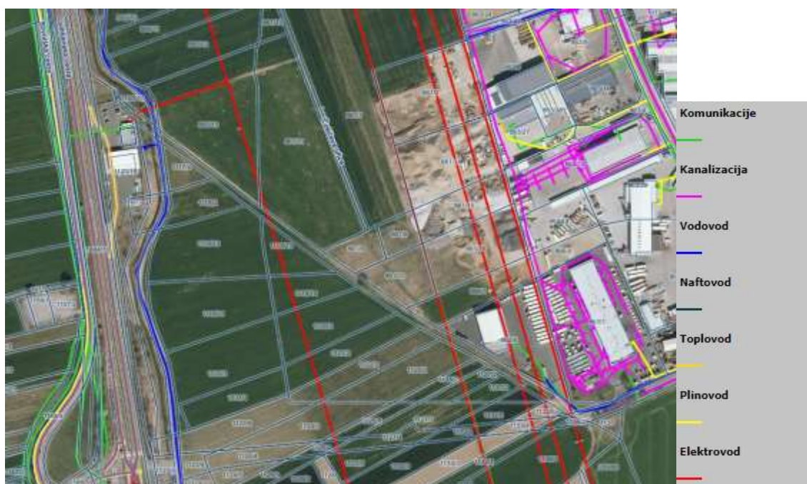
Slika 5: Območje z obstoječimi komunalnimi vodami Vir: https://www.geoprostor.net/piso_int/ewmap.asp?obcina=HOCE_SLIVNICA
