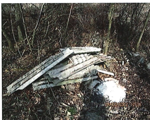
Slika 3; Nevarni odpadki - azbestne plošče
